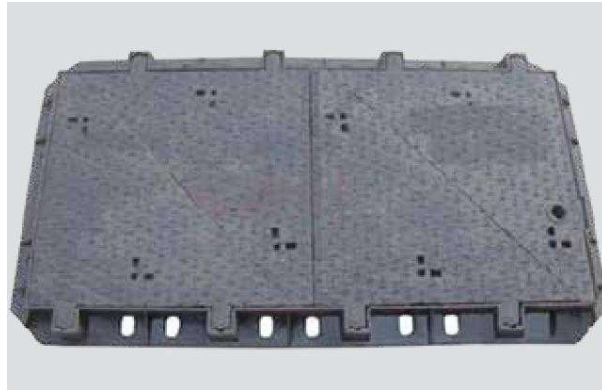
NẮP BỀ CÁP GANG CẦU 4 CÁNH KT 1600×950 TẢI TRỌNG 40T Model: NBC- 1695-01 / Tiêu chuẩn: EN124
