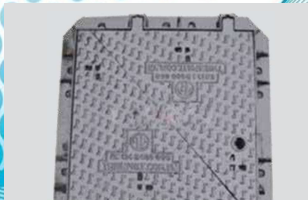
NẮP BỂ CẤP GANG CẦU 2 CÁNH KT 1000X647X80 TẢI TRỌNG 12,5T Model: NBC- 1064-01 / Tiêu chuẩn: EN124
