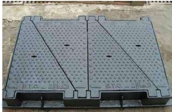
NẮP BỂ CẤP KT: 155×884 TẢI 12,5T Model: NBC-155x884 / Tiêu chuẩn: BS EN124
