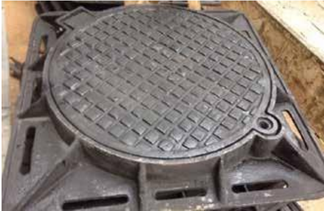
NẮP HỐ GA KHUNG VUÔNG ÂM NẮP TRÒN KT: 850×850 TẢI TRỌNG 40T Model: NHG - KA840 / Tiêu chuẩn: BS EN124
