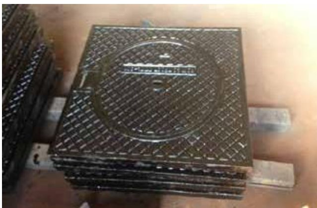
NẮP HỐ GA KHUNG VUÔNG DƯƠNG NẮP TRÒN KT: 900×900 TẢI TRỌNG 40T Model: NHG-KD9004 / Tiêu chuẩn: BS EN124
