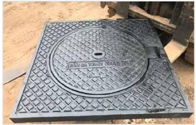
NẮP HỐ GA GANG XÁM KHUNG VUÔNG DƯƠNG NẮP TRÒN / KT 850×850 TẢI TRỌNG 7,5T Model: NHX D8585-03 / Tiêu chuẩn: EN124
