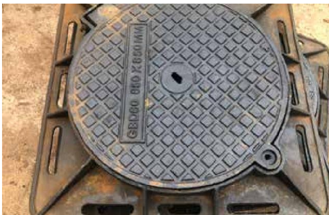
NẮP HỐ GA GANG CẦU KHUNG VUÔNG ÂM NẮP TRÒN / KT 900×900 TẢI TRỌNG 40T Model: NHC A9040 / Tiêu chuẩn: EN124
