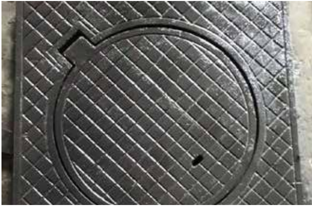
NẮP HỐ GA GANG XÁM KT: 900×900 TẢI TRỌNG 7,5T Model: NHG 9001 / Tiêu chuẩn: BS EN124
