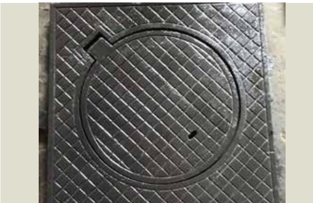
NẮP HỐ GA GANG XĂM KT: 900×900 TẢI TRỌNG 7,5T Model: NHG 9001 / Tiêu chuẩn: BS EN124
