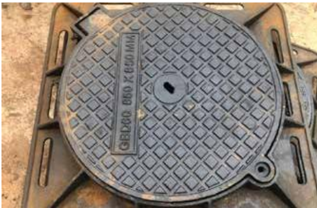
NẮP HỐ GA GANG CẦU KHUNG VUÔNG ÂM NẮP TRÒN / KT 800×800 TẢI TRỌNG 40T Model: NHC A8040 / Tiêu chuẩn: EN124
