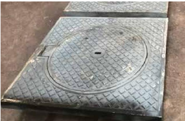
NẮP HỐ GA GANG XÁM KHUNG VUÔNG DƯƠNG NẮP TRÒN / KT 850×850 TẢI TRỌNG 25T Model: NHX D8585-01 / Tiêu chuẩn: EN124
