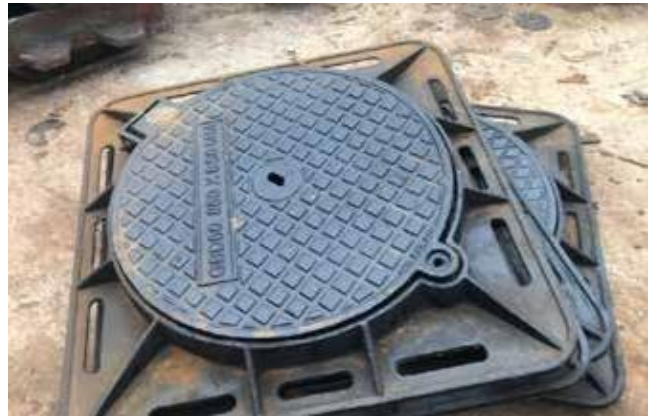
NẮP HỐ GA GANG CẦU KHUNG VUÔNG ÂM NẮP TRÒN / KT 850×850 TẢI TRỌNG 60T Model: NHC A8560 / Tiêu chuẩn: EN124
