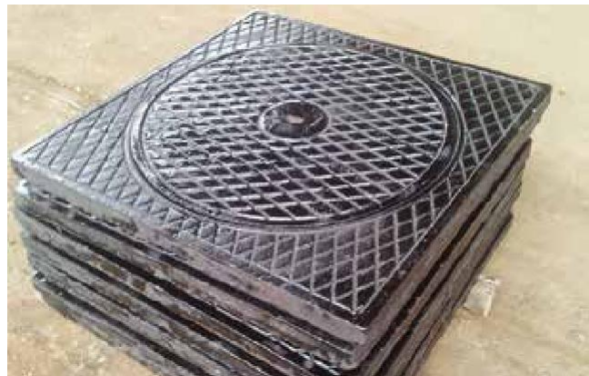
NẮP HỐ GA GANG CẦU KT 900×900 (650) TẢI TRỌNG 12.5T Model: NHG-0217 / Tiêu chuẩn: BS EN124
