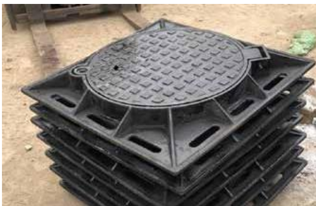
NẮP HỐ GA GANG CẦU KHUNG VUÔNG ÂM NẮP TRÒN / KT 850×850 TẢI TRỌNG 25T Model: NHC A8525 / Tiêu chuẩn: EN124
