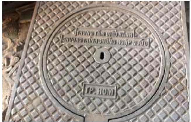
NẮP HỐ GA GANG XÁM KHUNG VUÔNG DƯƠNG NẮP TRÒN / KT 900×900 TẢI TRỌNG 25T / Model: NHX D9090-01 / Tiêu chuẩn: EN124
