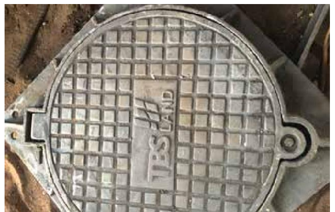
NẮP HỐ GA GANG CẦU KHUNG VUÔNG ÂM NẮP TRÒN / KT 800×800 TẢI TRỌNG 25T Model: NHC A8025 / Tiêu chuẩn: EN124
