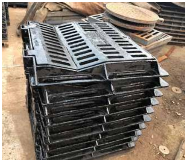
SONG CHẮN RÁC GANG XÁM KT 960×530 TẢI TRỌNG 1,5T Model: SCRX: 9653 / Tiêu chuẩn: EN124
