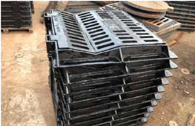
SONG CHẮN RÁC GANG CẦU KT 960×530 TẢI TRỌNG 40T Model: SCRC: K9653 / Tiêu chuẩn: EN124
