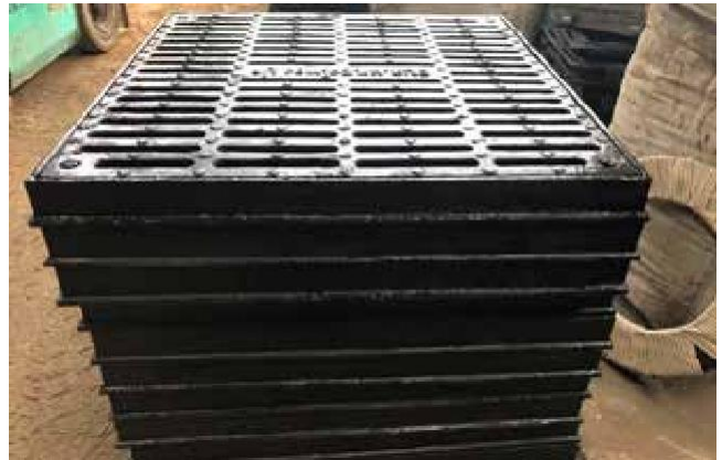
SONG CHẮN RÁC GANG CẦU KT 950×280 TẢI TRỌNG 12,5T Model: SCRC: K9528 / Tiêu chuẩn: EN124
