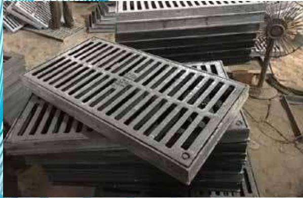
SONG CHẮN RÁC VÀ KHUNG GANG CẦU KT: 1140X600X75 TẢI TRỌNG 25T Model: SCR 1140 / Tiêu chuẩn: BS EN124
