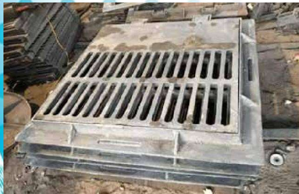
NẮP HỘ GA THU THẨM KẾT HỢP KT: 1200x1200x75 TẢI TRỌNG 12.5T Model: / Tiêu chuẩn: BS EN124
