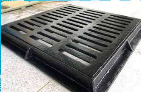
SONG CHẮN RÁC GANG CẦU CÓ KHUNG KT 960×530 TẢI TRỌNG 12,5T Model: SCRC: K960x530 / Tiêu chuẩn: EN124
