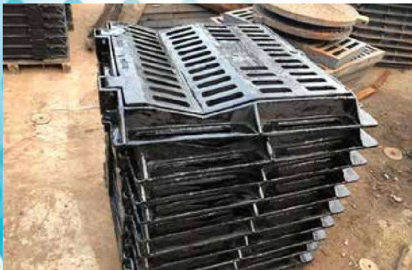
SONG CHẮN RÁC GANG CẦU KT 960×530 TẢI TRỌNG 40T Model: SCRC: K9653 / Tiêu chuẩn: EN124
