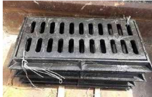
SONG CHẮN RÁC VÀ KHUNG GANG CẦU KT: 960×530 TẢI TRỌNG 12.5T Model: SCR 960 / Tiêu chuẩn: BS EN124
